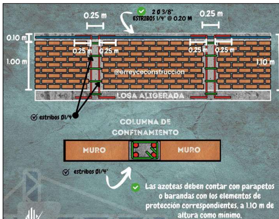
Figura 69: Partes del parapeto.
