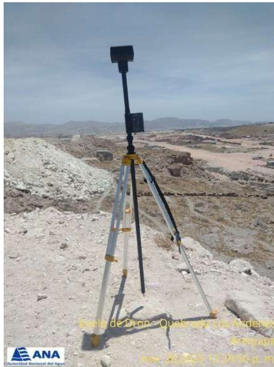
Ilustración 28 - Georreferenciación a la red geodésica nacional (IGN) del punto
