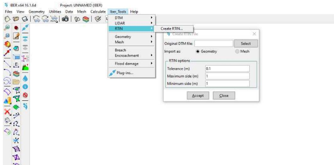
*Ilustración 36 – Importación del archivo ASCII y creación de la Geometría RTIN de la Quebrada Los Andenes en el software Iber.*
