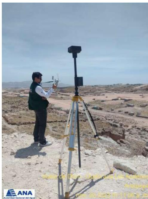
*Ilustración 32 – Operación del Vehículo aéreo no tripulado DRONE para Levantamiento Topográfico en Campo*
