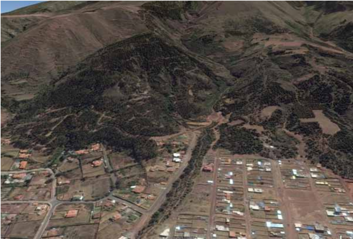
Figura 22: Deslizamientos en ambas márgenes del río Cachimayo, debido a su alta pendiente y la presencia de factores desencadenantes como las lluvias intensas y presencia de sismicidad debido a las fallas activas dentro en esta región.
