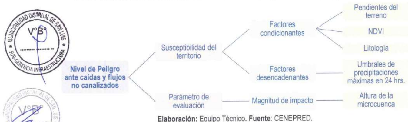
Figura 13. Metodología general para determinar el nivel de peligro ante caídas y flujos no canalizados.
