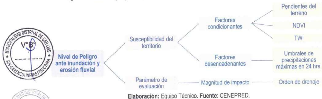
Figura 11. Metodología general para determinar el nivel de peligro ante inundación y erosión fluvial
