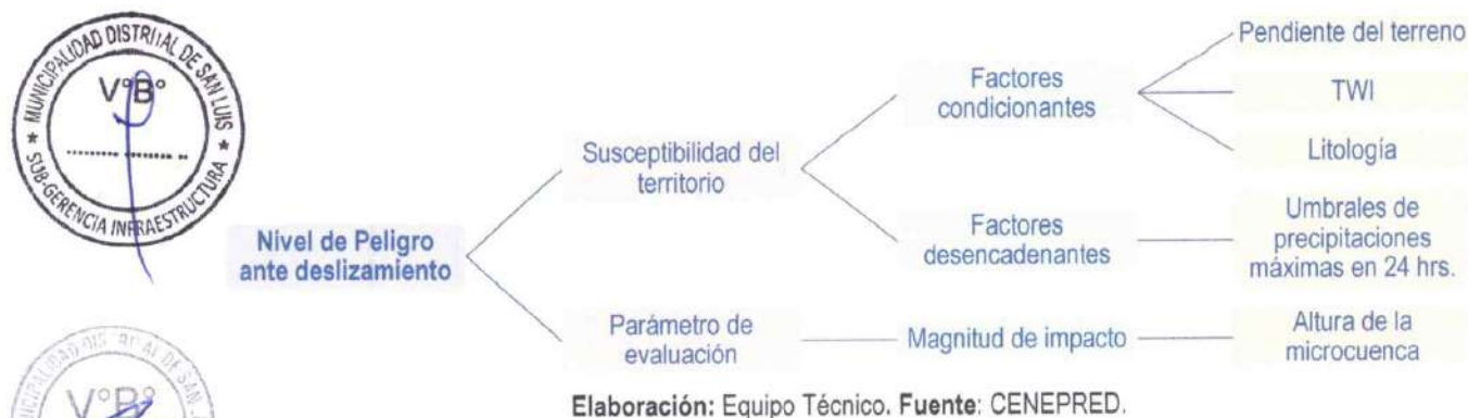
Figura 17. Metodología general para determinar el nivel de peligro ante deslizamiento
