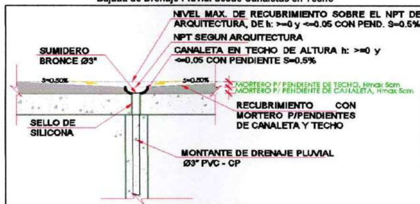
Bajada de Drenaje Pluvial desde Canaletas en Techo
