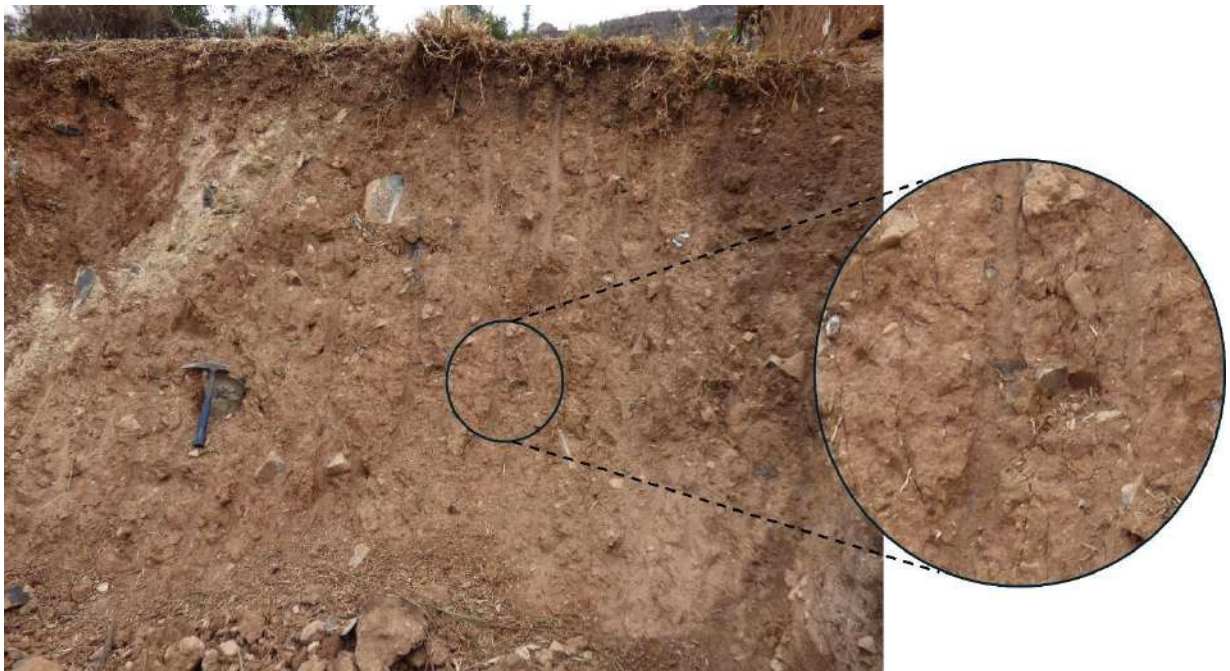
Figura 8. Vista del depósito coluviodeluvial conformado por clastos subredondeados a subangulosos heterométricos con tamaños que van de 1-70 cm envueltos en una matriz arcillo-limosa, el depósito se muestra húmedo. Coordenadas UTM 18L 2047571E; 8982217N.
