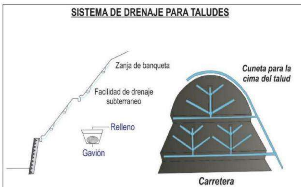
Figura 37. Drenaje tipo espina de pescado. Tomado de INGEMMET (2000).
