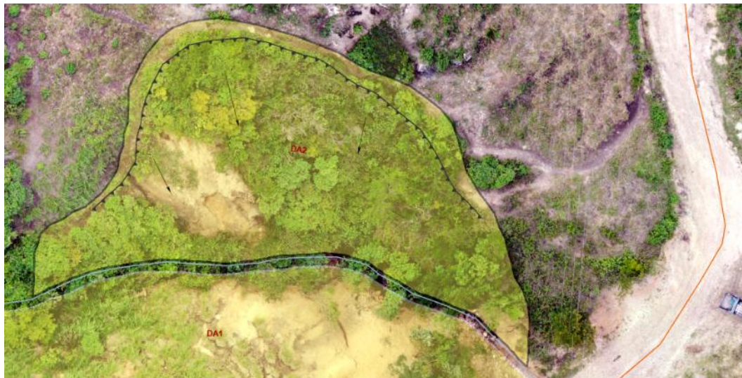
Figura 17. Deslizamiento rotacional activo – DA2 (línea gris), con afectación de terrenos de cultivo y obstrucción temporal del cauce de la quebrada.
