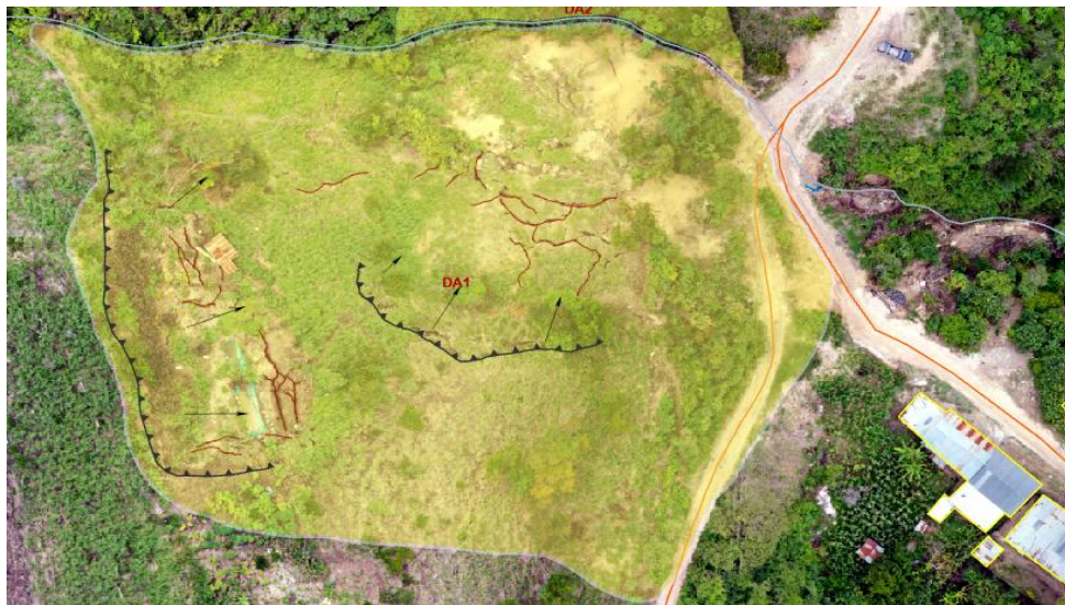
Figura 11. Se observa el deslizamiento rotacional activo – DA, con presencia de agrietamientos (línea roja); afecta vías y terrenos de cultivo.
