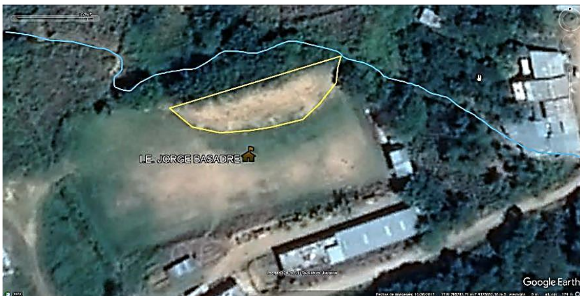
Figura 10. Imagen satelital del 2017, muestra movimiento en masa, dentro de la línea amarilla, que coincide con el movimiento evaluado en julio del 2025. Fuente: Google Earth.
