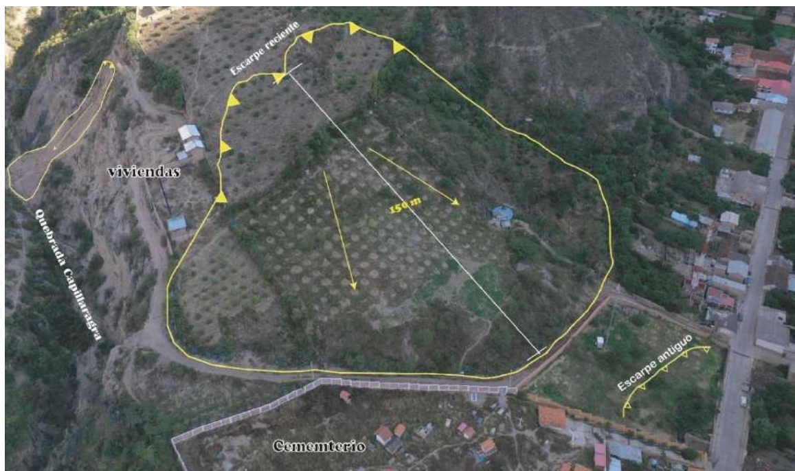
Figura 17. Vista aérea tomada con dron del deslizamiento rotacional activo. La masa se ha desplazado ladera abajo. De continuar el movimiento podría alcanzar las viviendas de Rahuapampa.
