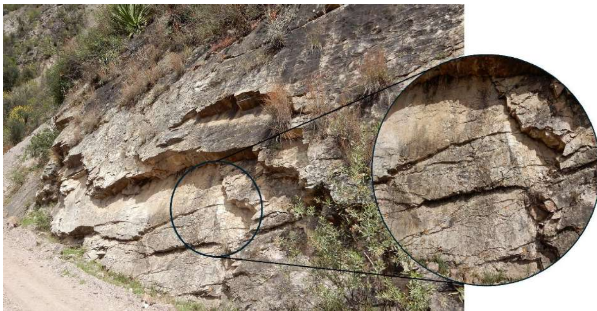
Figura 6. Vista de areniscas de grano medio a fino muy fracturado y moderadamente meteorizado, ubicado en las coordenadas UTM 18L 271931E; 8964135 N.
