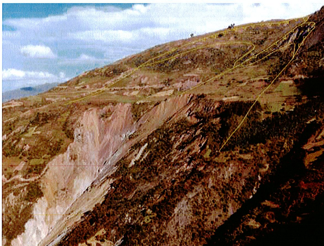
Foto 6: Vista panorámica del sector de Huachirpampa, donde se ha resaltado con líneas amarillas la escarpa de deslizamiento antiguo.
