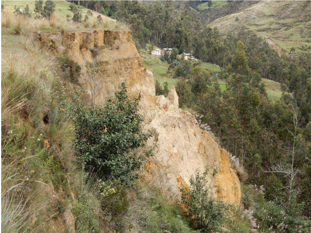
Fotografía 2. Depósito coluvial, dispuesto al pie de las laderas, compuesto por gravas, arenas, limos y arcillas.
