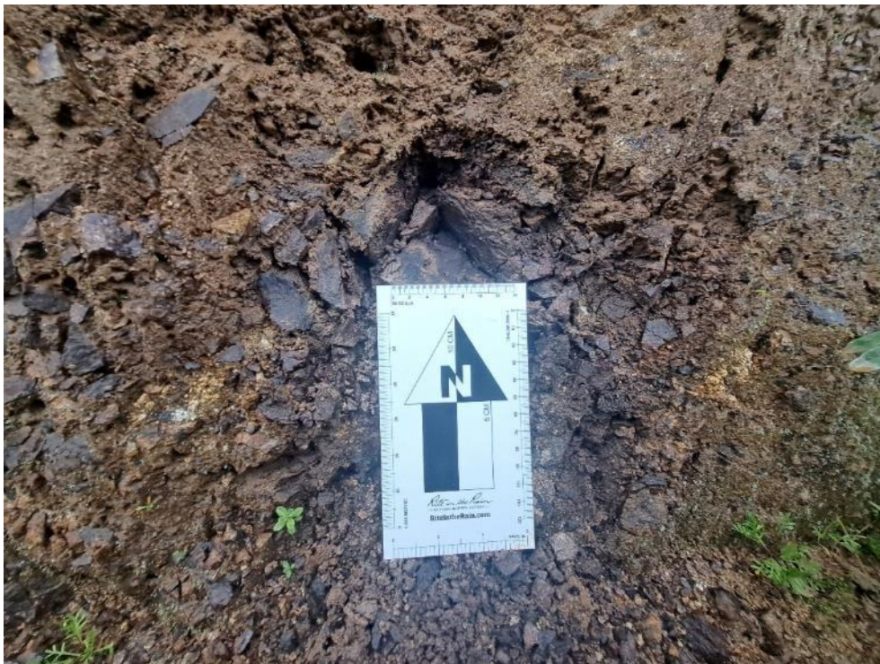
Fotografía 1. Vista del lente de 40 cm de espesor correspondiente a la Fm. Carhuaz compuesto por areniscas gris verdosas y lutitas negras; altamente meteorizadas y fragmentadas.
