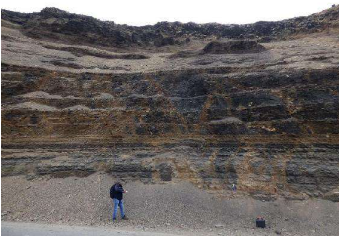
Fotografía 3. Detalle de la parte inferior (base) de la Formación La Herradura. Lutitas negras en bancos delgados. Se observa características físicas del afloramiento con aspecto fisible típicas de las lutitas. Nótese el macizo rocoso muy fracturado y de moderado a fuertemente meteorizado. Vista mirando al noreste.
