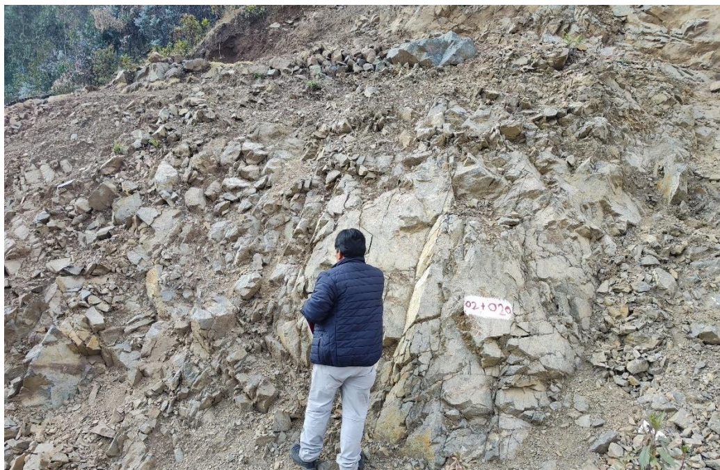
Fotografía 1. Meta-andesita medianamente a muy fracturada y moderadamente meteorizada, coordenadas UTM WGS84 18M. 204011, 911625.
