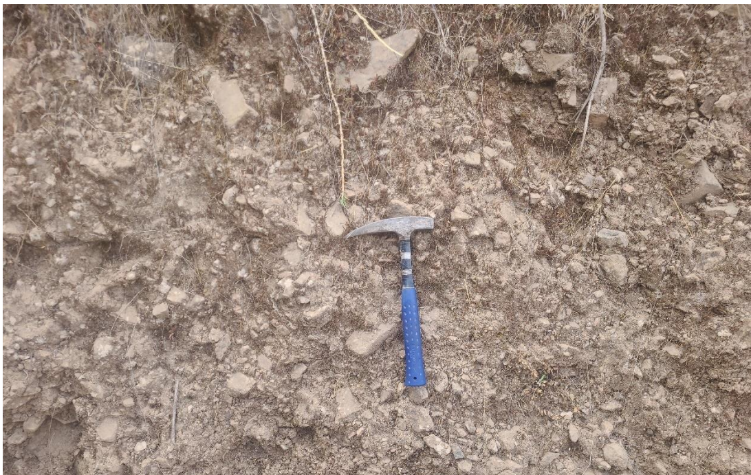
Fotografía 3. Se observa un depósito coluvio-deluvial, compuesto por bloques y gravas angulosas, en matriz limo arenosa. Coordenadas UTM WGS84 17M. 203696, 9116206.
