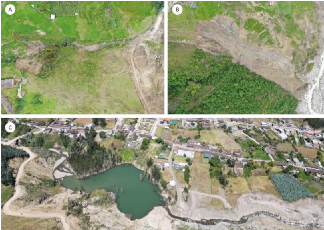
Figura 20. Las imágenes muestran el flujo de detritos que se originó por el material del deslizamiento, en dirección al río Sarín
