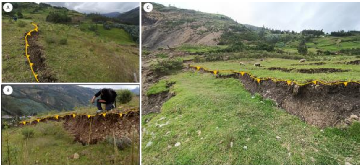
Figura 15. En las imágenes A, B y C se observan escarpes secundarios con un salto promedio de 1.2 m a 1.7 m.
