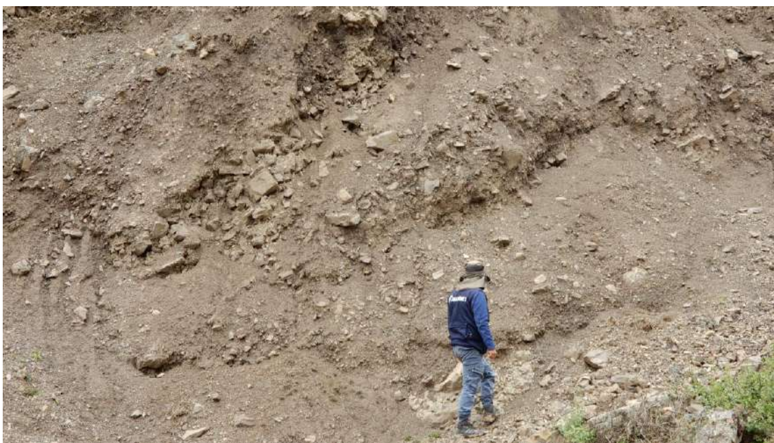
Fotografía 2. Depósito coluvio deluvial, se presenta medianamente consolidado.
