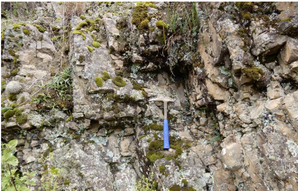
Fotografía 1. Areniscas intercaladas con lutitas y limolitas. Se presentan de mediana a muy fracturada.
