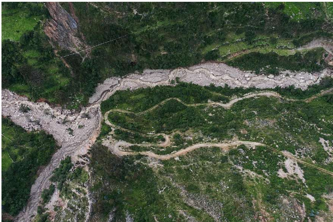
Fotografía 22: Vista de la confluencia de la quebrada Caucera con la quebrada Chinchilla y el material detrítico de los eventos de flujos de detritos, los cuales podrían afectar la trocha carrozable Sahuaraura – Chinchiña y el puente Chinchilla.
