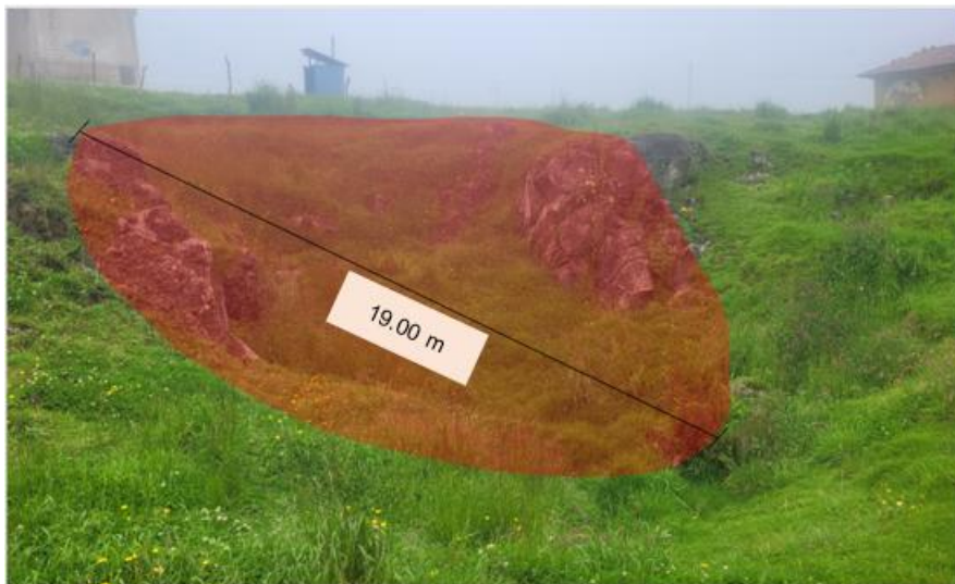
Figura 12: Hundimiento 01, ubicado al SE de la zona de estudio (E:824163 N: 9213306), con un área de 0.030 ha y 19.0 metros de diámetro.
