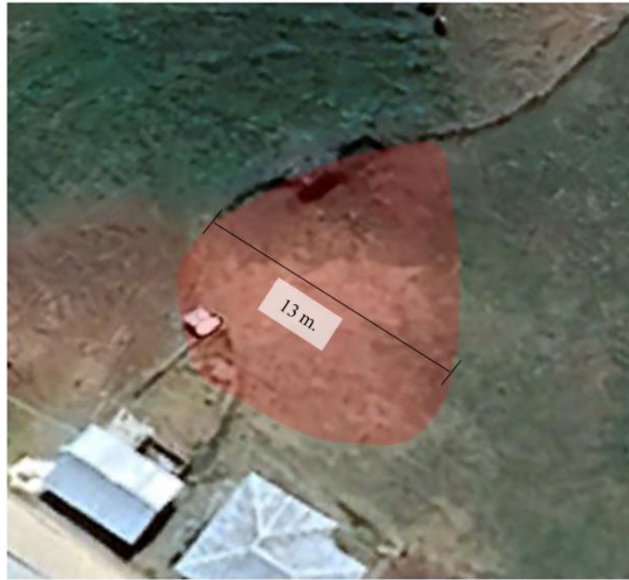
Figura 10: Hundimiento 01, ubicado al NW de la zona de estudio (E:823940 N: 9213450), con un área de 0.04 ha y 13.0 metros de diámetro.
