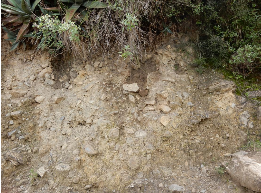
Fotografía 2. Depósito coluvio deluvial, compuestos por bloques angulosos a subangulosos, inmerso en matriz areno limosa.
