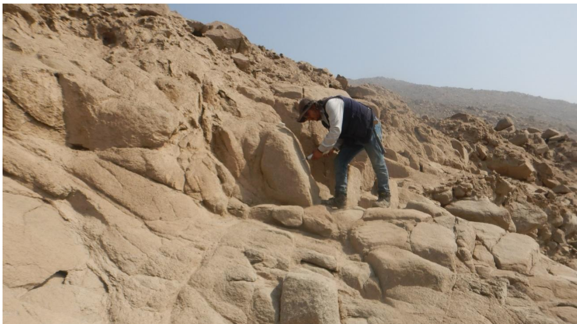
Fotografía 2. Ensayo con el martillo de Schmidt para la estimación de la resistencia de la matriz rocosa bajo la metodología de la ISRM (Sociedad Internacional de Mecánica de Rocas, 1981). Coordenadas referenciales UTM WGS-84, 18S: E: 307219; N: 8674437.
