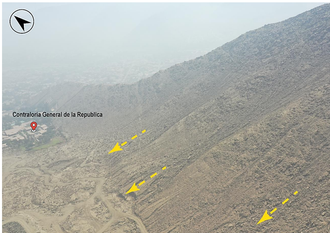
Figura 9. Margen derecho de la quebrada, donde se puede distinguir el basamento rocoso muy fracturado y meteorizado que contribuye a la acumulación de materiales coluviales y proluviales (flechas de color amarillo), susceptibles a ser removidos con facilidad durante lluvias excepcionales.
