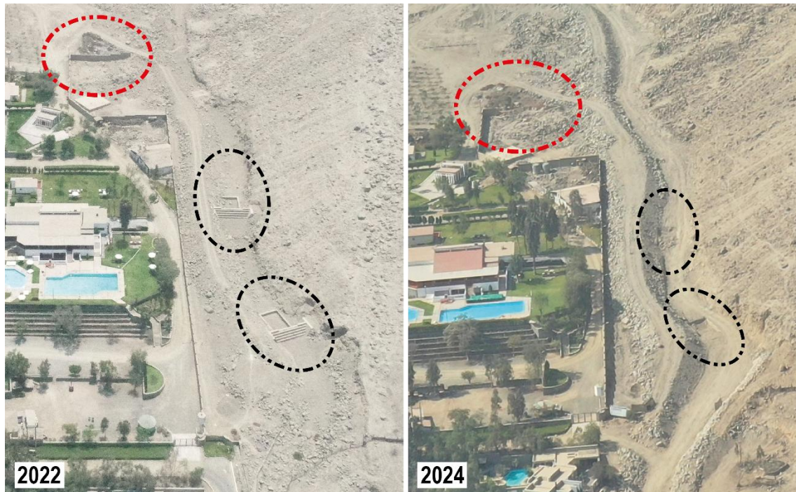
Figura 16. Comparación entre dos fotografías de dron (2022 y 2024), en donde se puede visualizar la destrucción de dos diques de concreto (líneas entrecortadas color negro), y una pared (líneas entrecortadas color rojo) producto del último fenómeno del Ciclón Yaku (2023).
