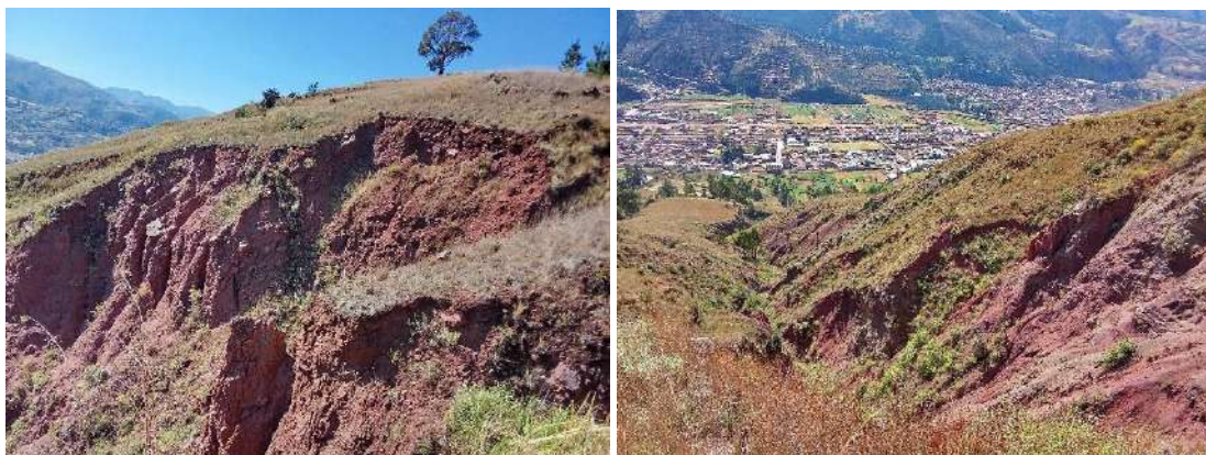
FOTOGRAFÍA 29: MATERIAL COLUVIO-DELUVIAL EN LAS LADERAS DE LA QUEBRADA HUESCONCORAY, SE OBSERVAN DESLIZAMIENTOS A LO LARGO DE LA QUEBRADA
