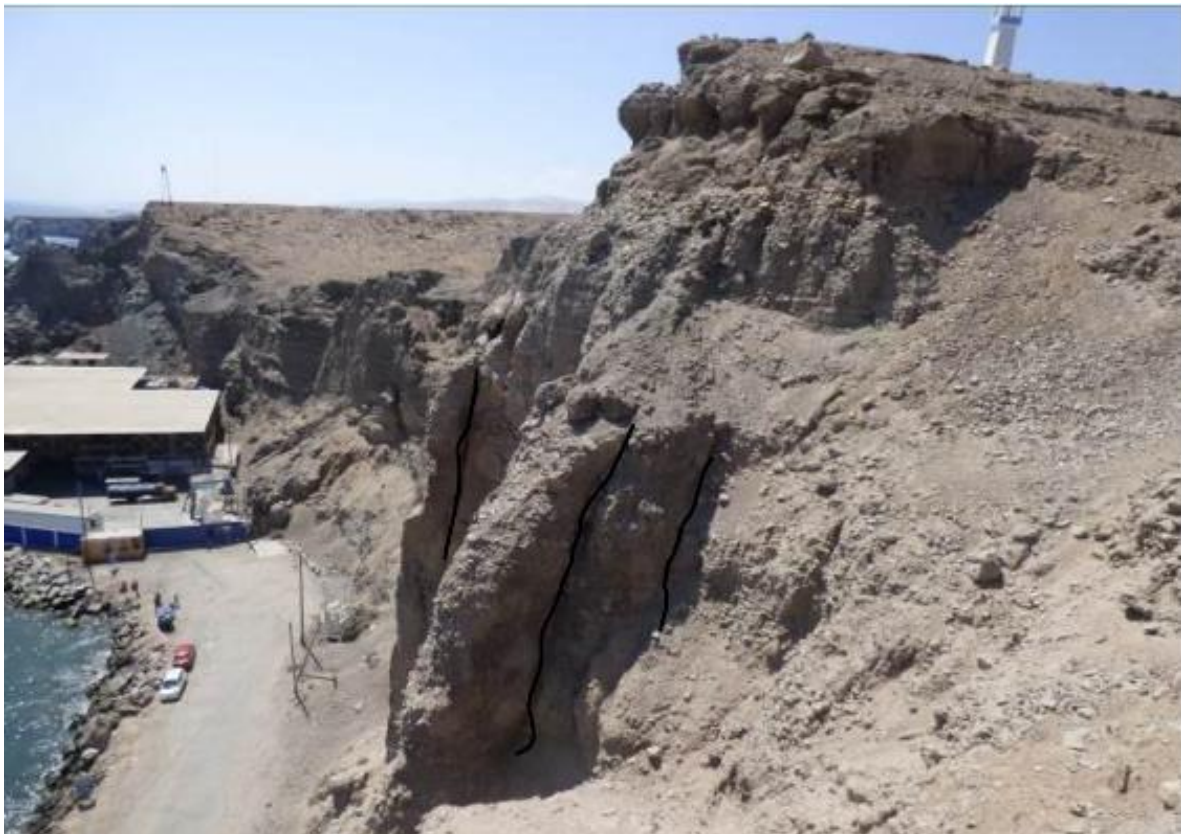
Figura 10. Vista tomada hacia el Norte, se observa afloramiento de la Fm. Millo conformado por conglomerados, areniscas tobáceas, lentes de tobas re TRABAJADOS, se aprecian grietas con dirección noroeste 10°, con presencia de lluvias que ocurren durante los meses de setiembre a octubre, estas aguas se infiltran, saturando y erosionando los sedimentos más finos debilitando el talud. Informe Técnico N°A6713, INGEMMET (2016).
