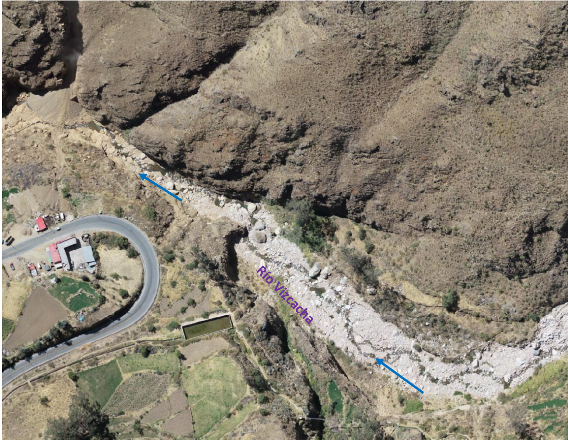
Figura 5. Se muestra el cauce de la quebrada con material (color blanquecino) que recientemente ha discurrido, proveniente del flujo de detritos.
