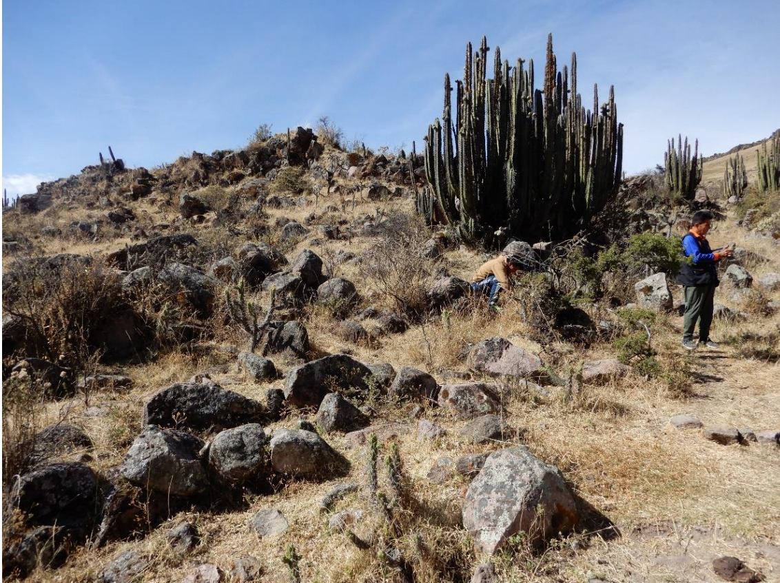
Fotografía 1. Se aprecia bloques heterométricos de tobas de formas subangulosas y subredondeadas.
