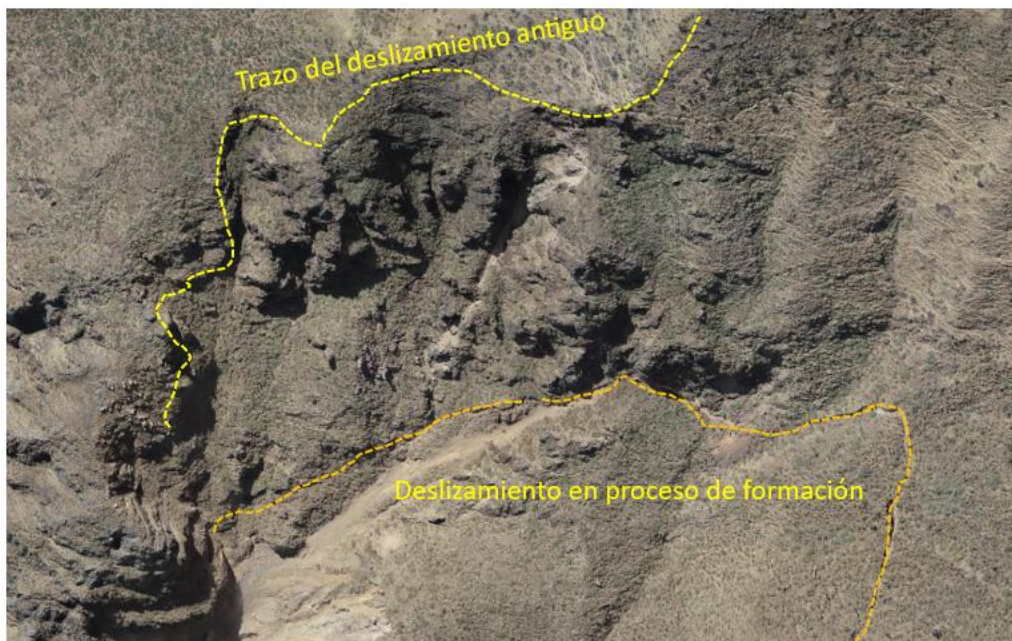
Figura 15. El trazo del deslizamiento antiguo (línea amarilla), y el trazo del deslizamiento en proceso de formación coincide con dirección noreste.
