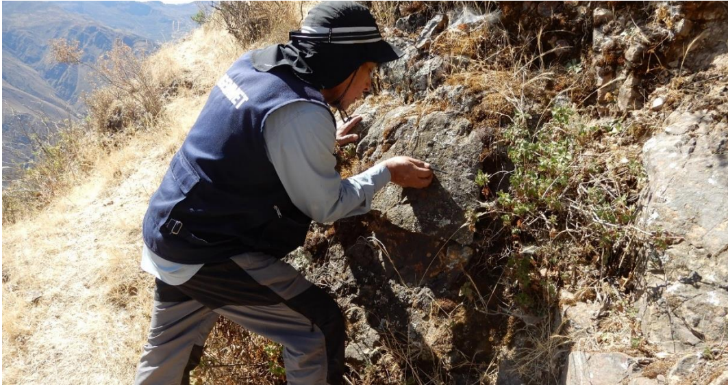
Fotografía 2. Se aprecia la escarpa del deslizamiento antiguo, y también afloramiento de tobas.
