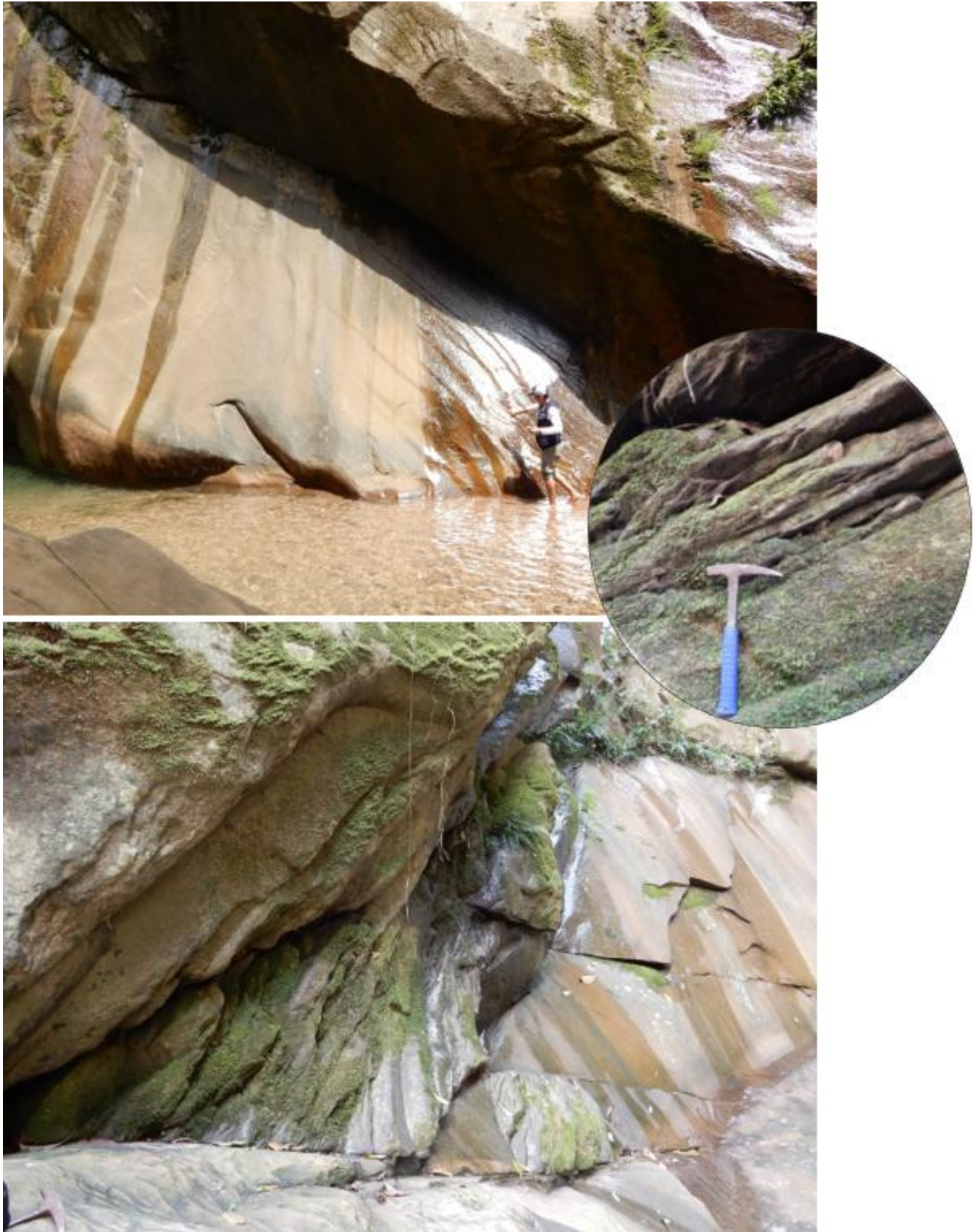
Figura 4. Areniscas rojizas, se presentan de mediana a muy fracturada y algunas zonas altamente meteorizadas debido al constante contacto el agua de escorrentía pluvial y de la catarata.
