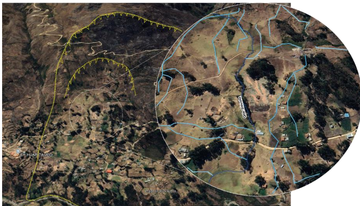
Figura 13. Vista de deslizamiento antiguo, donde se muestra mediante un zoom parte del cuerpo del deslizamiento donde se visualiza múltiples canales de riego rústicos.
