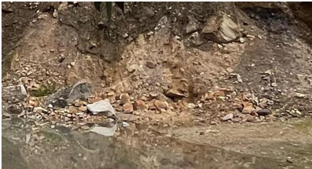
Fotografía 1. Vista del depósito coluvial conformada por bloques (20%), gravas (40%), arena (20%), arcillo-limoso (20%), se puede observar que corresponde a un depósito no consolidado, producto de derrumbes.
