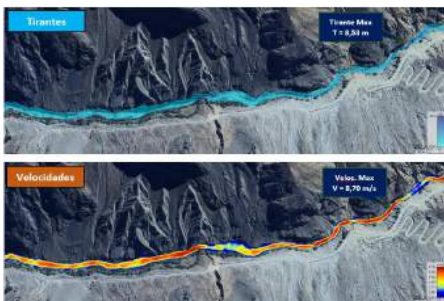
Figura 4: Resultado de tirantes y velocidades – Zona 02
