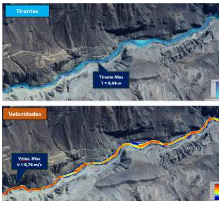
Figura 5: Resultado de tirantes y velocidades – Zona 03
