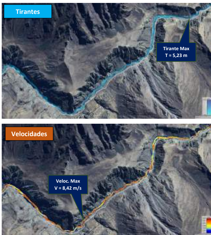
Figura 35: Resultado de tirantes y velocidades – Zona 04
