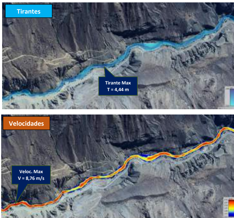
Figura 34: Resultado de tirantes y velocidades – Zona 03
