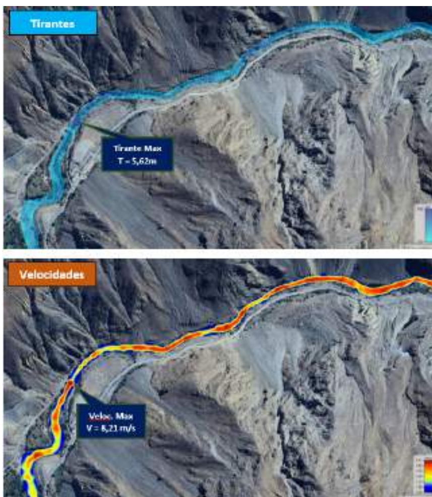
Figura 3: Resultado de tirantes y velocidades – Zona 01
