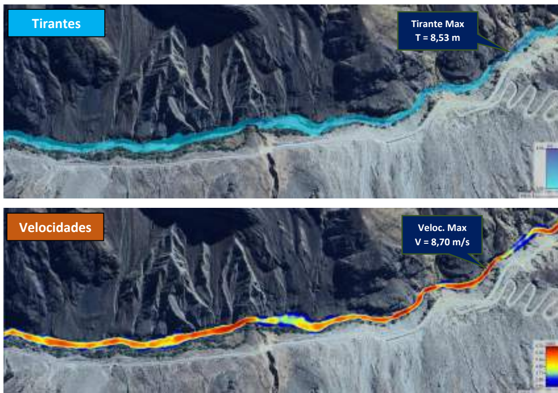
Figura 32: Resultado de tirantes y velocidades – Zona 02
