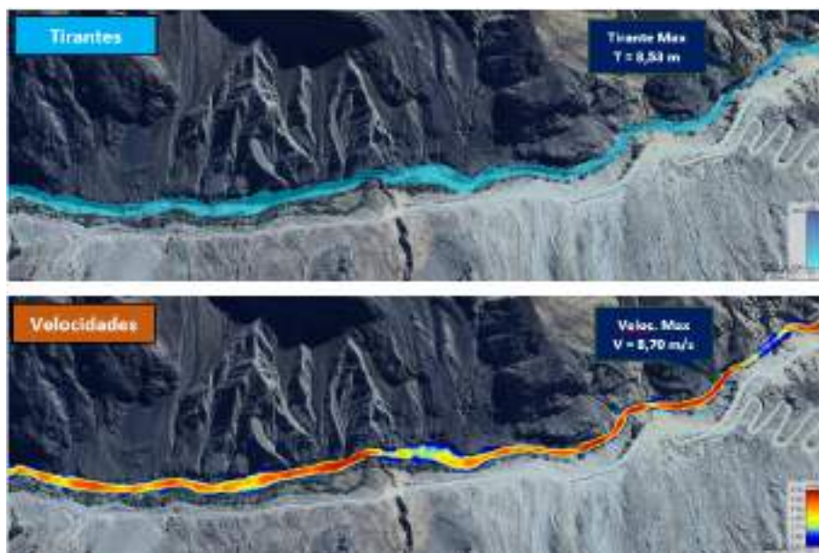
Figura 4: Resultado de tirantes y velocidades – Zona 02
