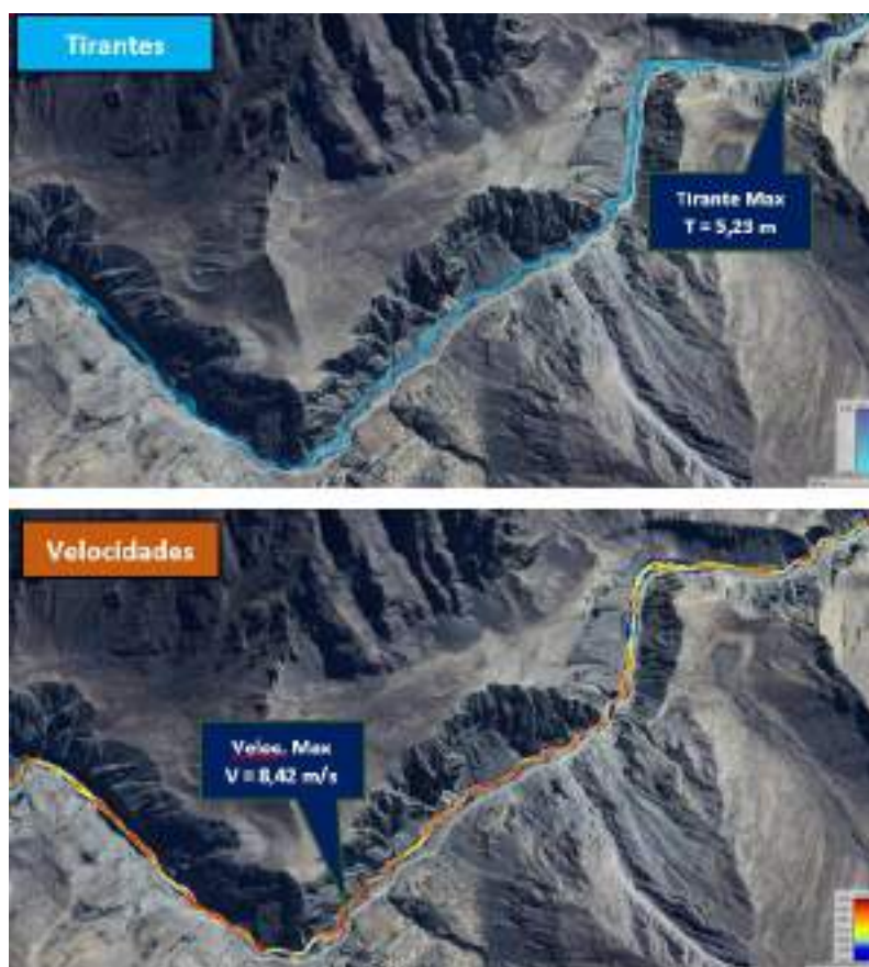
Figura 6: Resultado de tirantes y velocidades – Zona 04
