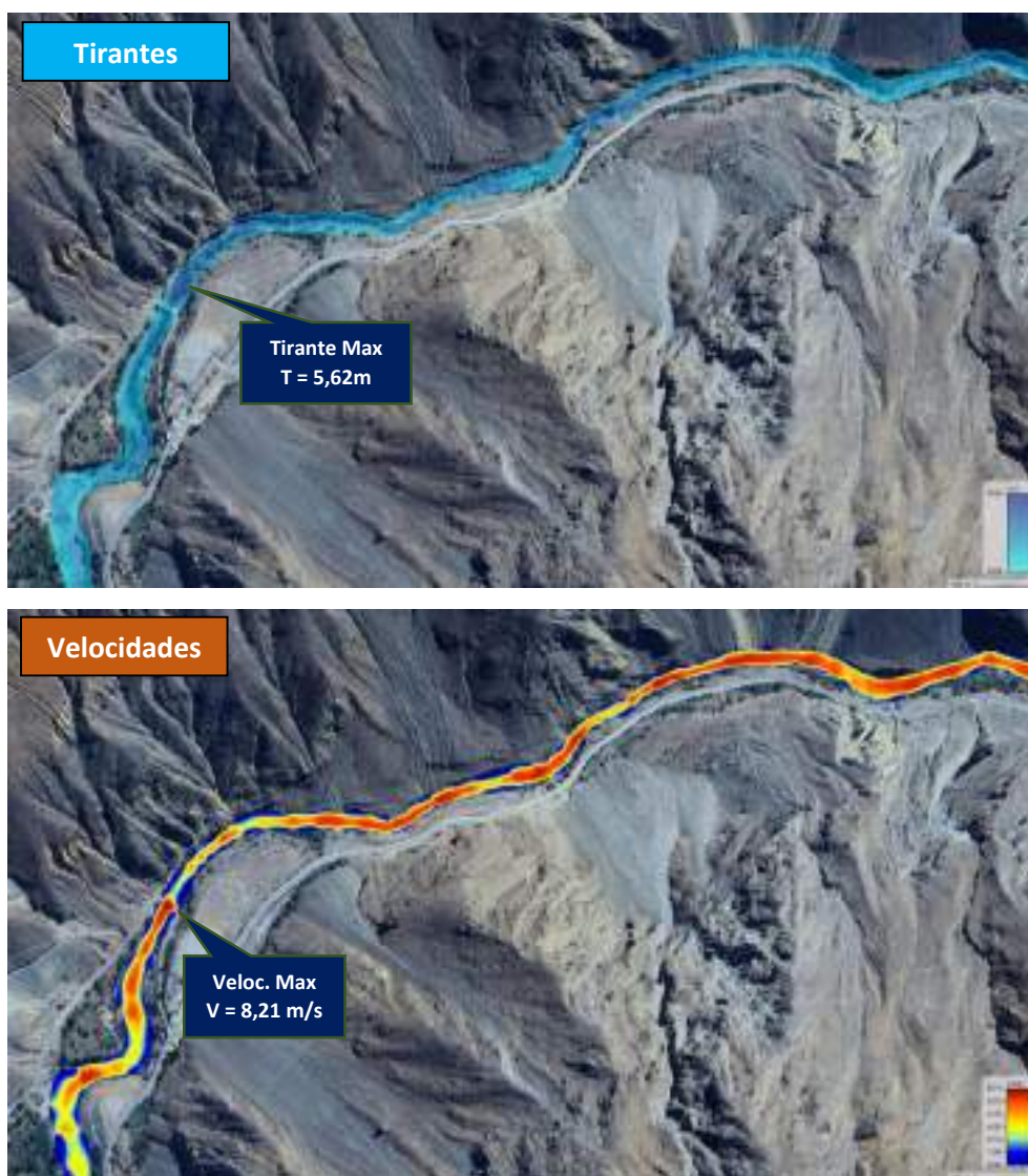
Figura 30: Resultado de tirantes y velocidades – Zona 01
