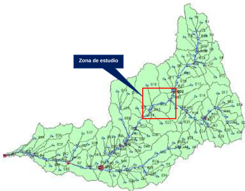
Figura 16: Esquema del modelo hidrológico para la cuenca del río Huaura
