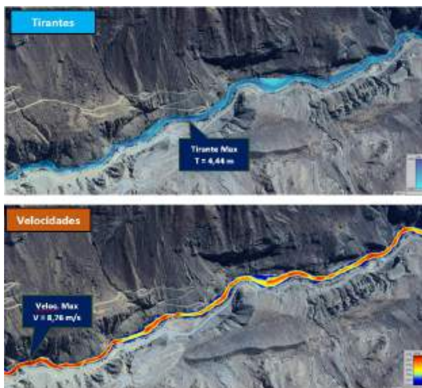
Figura 5: Resultado de tirantes y velocidades – Zona 03
