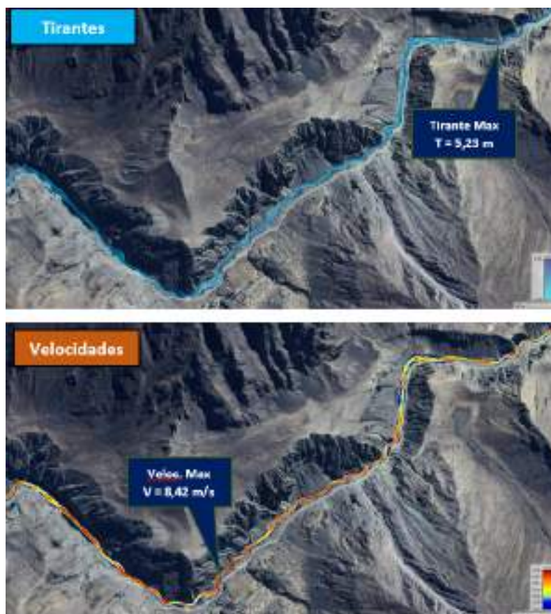
Figura 6: Resultado de tirantes y velocidades – Zona 04
