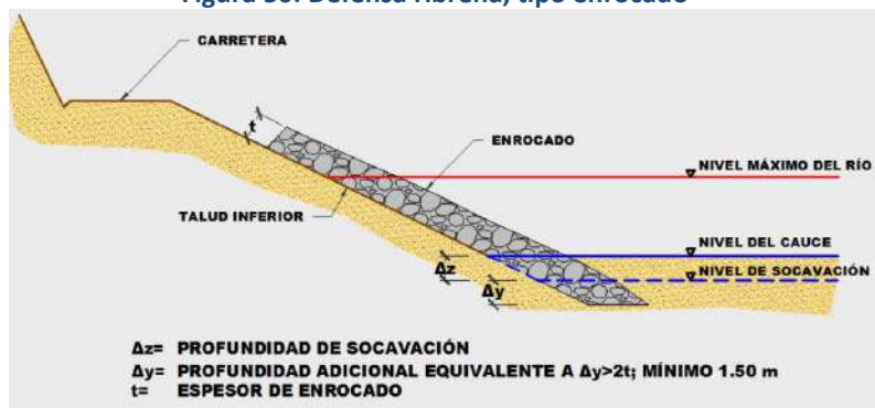
Figura 50: Defensa ribreña, tipo enrocado
