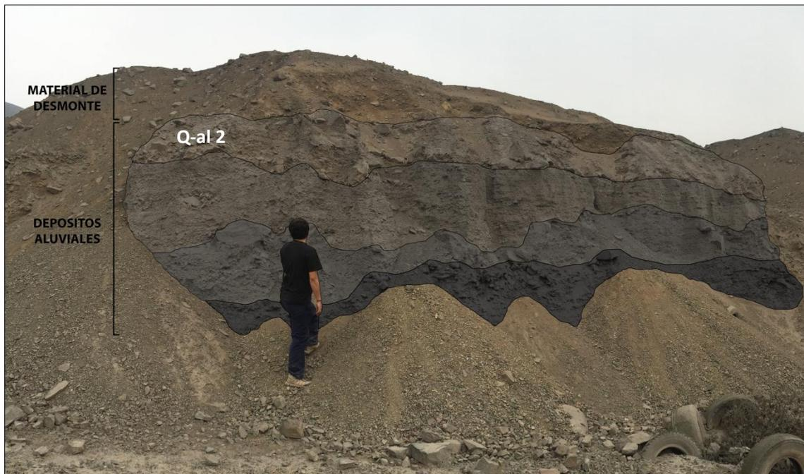
Figura 6. Se observa tres depósitos aluviales antiguos al depósito Q-al2 que corresponden a eventos aluviónicos originados por las lluvias del fenómeno de El Niño o lluvias de trasvase.
