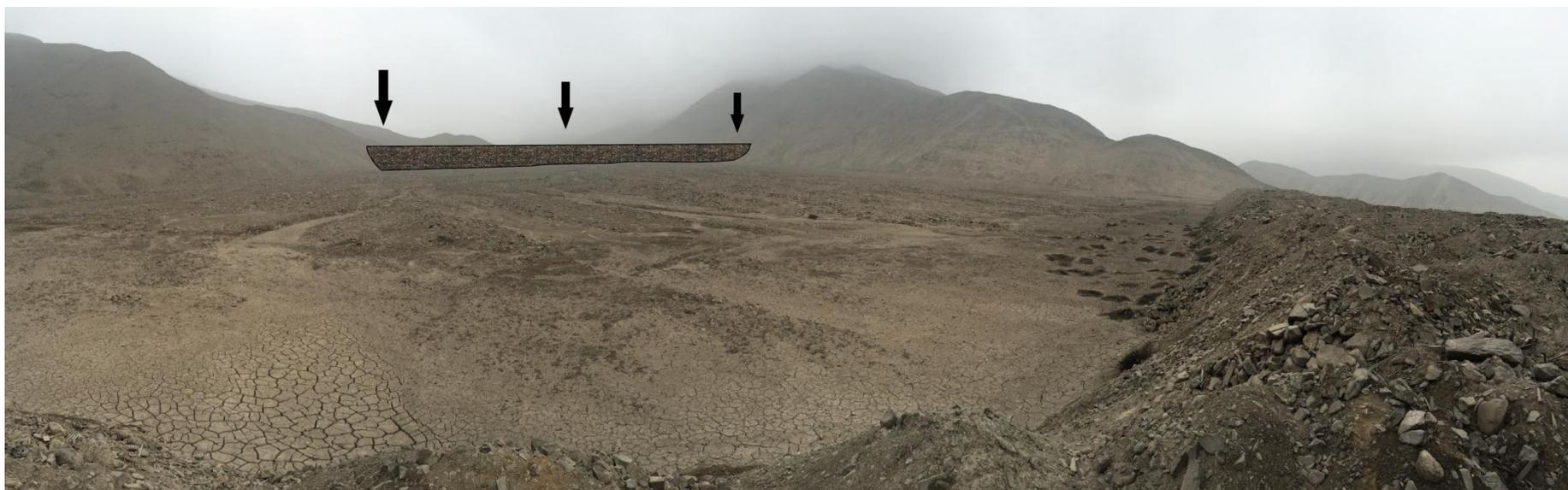
Anexo 2. Modelo para la construcción de dique y la propuesta para su ubicación a 350m aguas arriba del dique antiguo, la construcción puede ser con gaviones o mampostería; estos con sumideros para que discurran los excedentes (agua).
