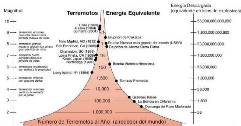
Figura 28: Relación de Magnitud con la cantidad de explosivos de alto voltaje requerido para producir la energía generada por un terremoto
