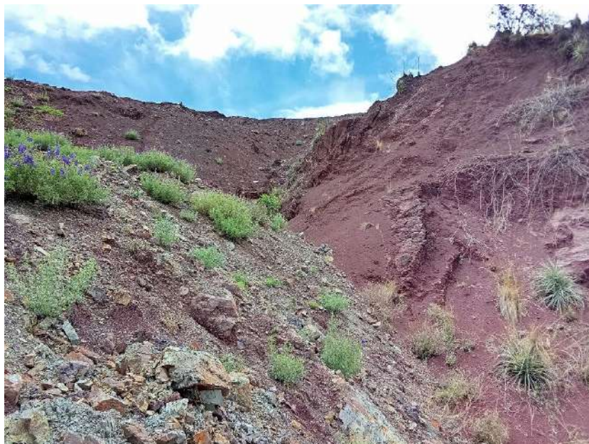
FOTOGRAFÍA 12: MATERIAL SUELTO, POCO CONSOLIDADO, SUSCEPTIBLE A MOVIMIENTOS EN MASA ANTE PRECIPITACIONES INTENSAS.
