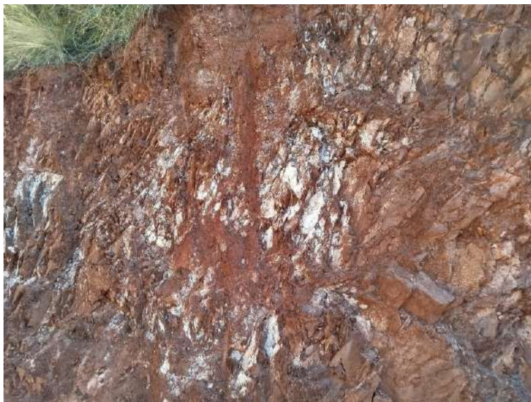
FOTOGRAFÍA 5: ARENISCAS CALCÁREAS DE COLORACIÓN ROJIZAS CON PRESENCIA DE YESO.
