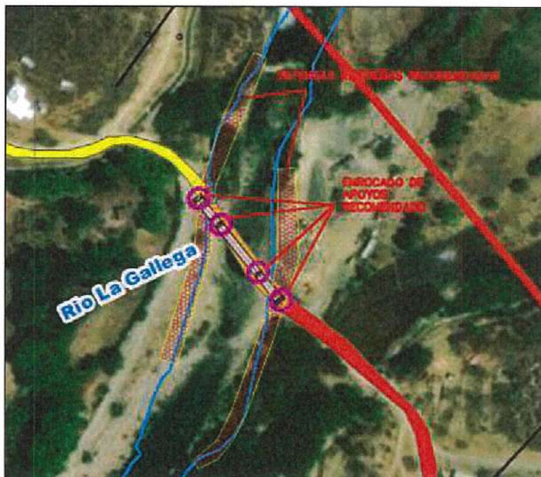
Ilustración 26: Medidas estructurales recomendadas en las inmediaciones del río La gallega (Puente Gallega).
