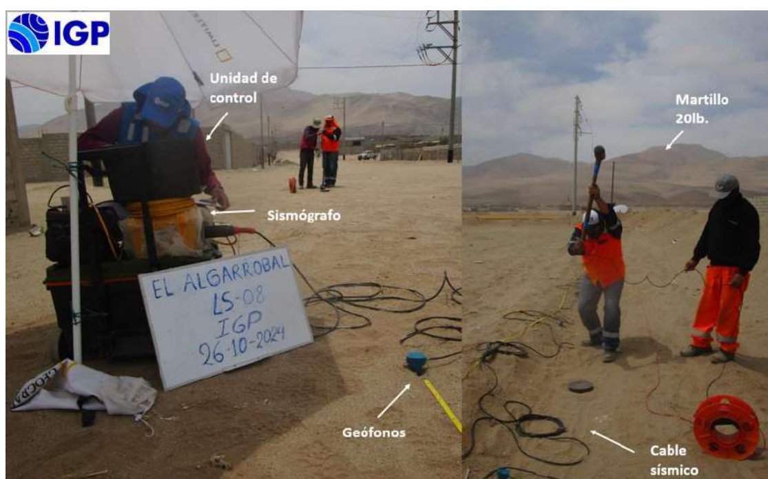
Figura 28: Equipos utilizados en la adquisición de datos MASW – MAM, en el área urbana del Algarrobal.
