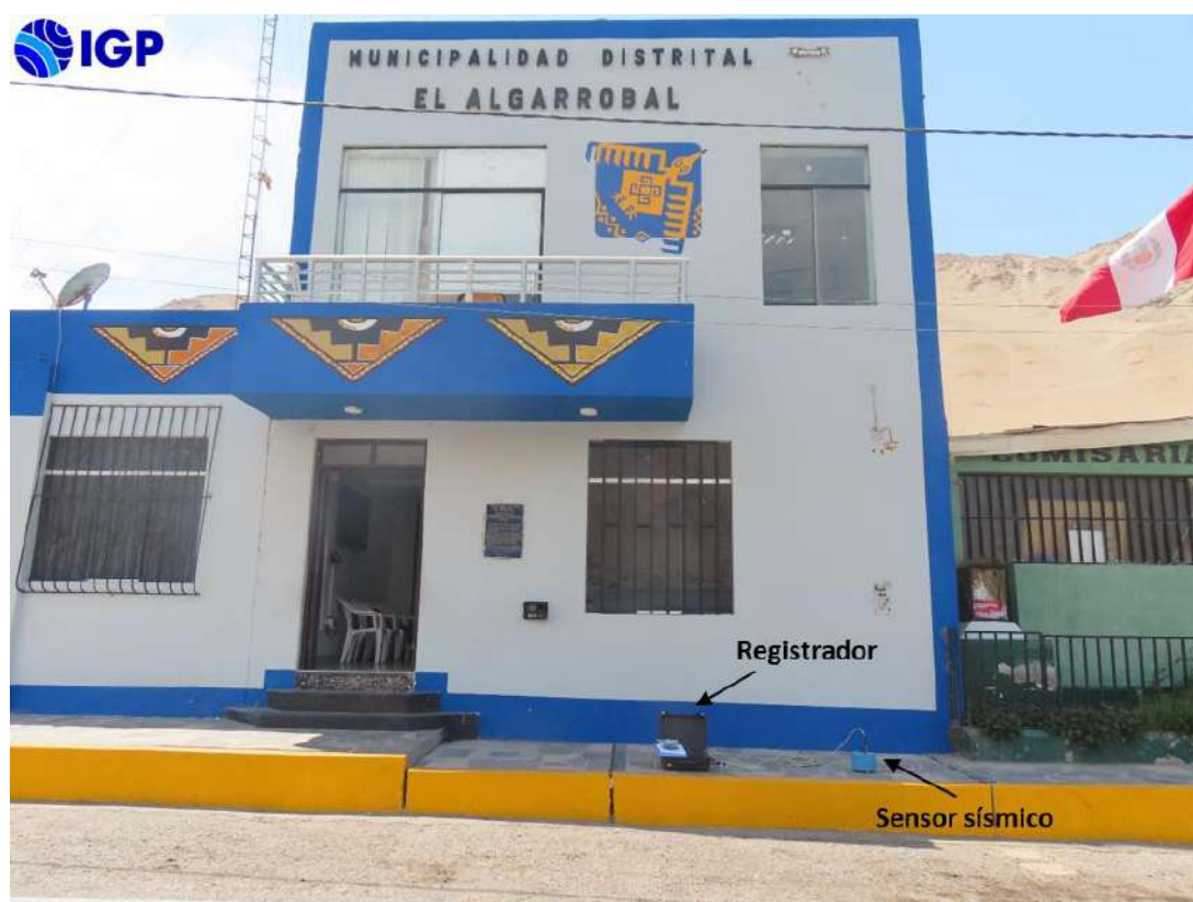
Figura 22: Equipo sísmico utilizado para el registro de vibraciones ambientales: sensor Lennartz (2N) y registradores CityShark II.
