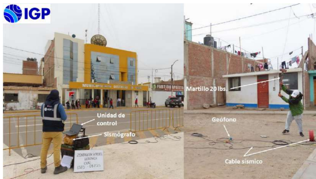
Figura 18. Equipos utilizados en la adquisición de datos MASW – MAM, en el área urbana de Chao.
