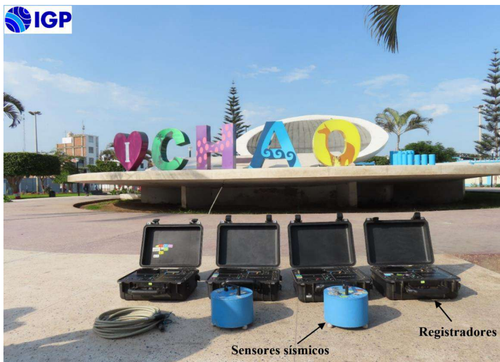
Figura 12. Equipo sísmico utilizado para el registro de vibraciones ambientales: sensor Lennartz (2N) y registradores CityShark II.
