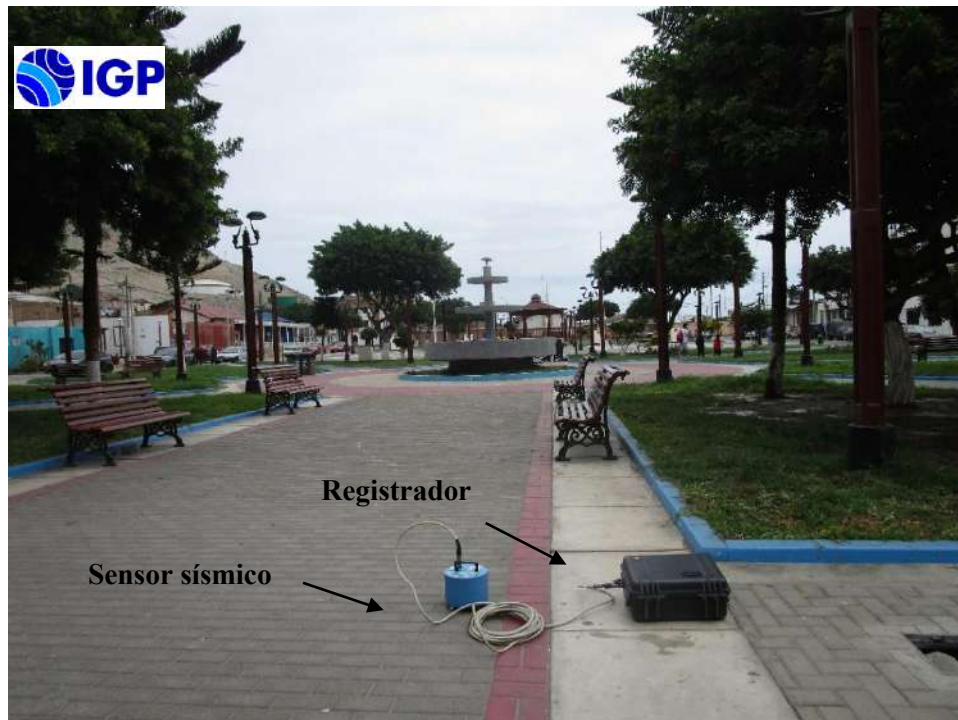
Figura 13. Equipo sísmico utilizado para el registro de vibraciones ambientales: sensor Lennartz (2N) y registradores CityShark II.
