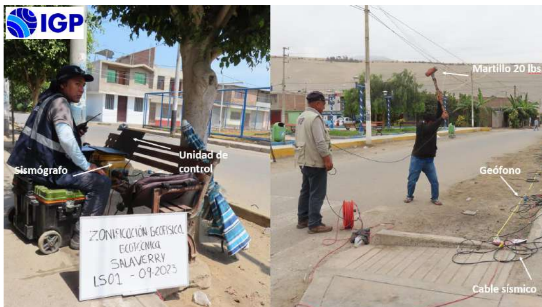
Figura 19. Equipos utilizados en la adquisición de datos MASW – MAM, en el área urbana de Salaverry.
