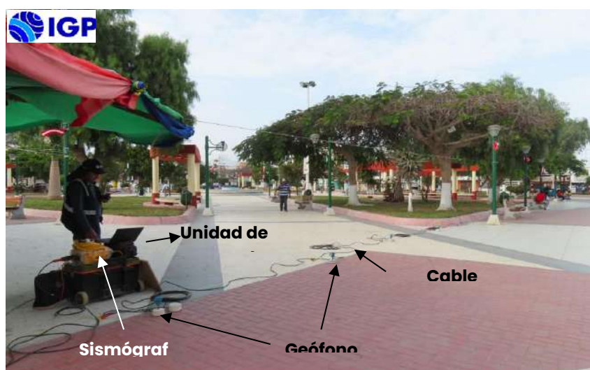
Figura 22. Equipos utilizados en la adquisición de datos MASW – MAM, en la plaza de Armas de Santa.
