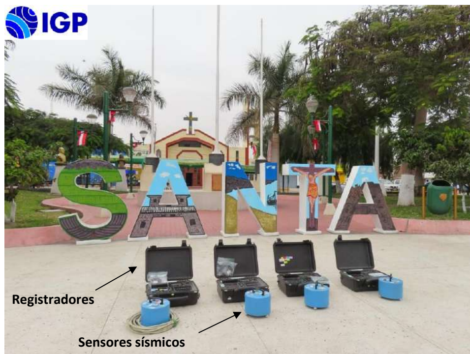
Figura 16. Equipo sísmico utilizado para el registro de vibraciones ambientales: sensor Lennartz (2N) y registradores CityShark II.
