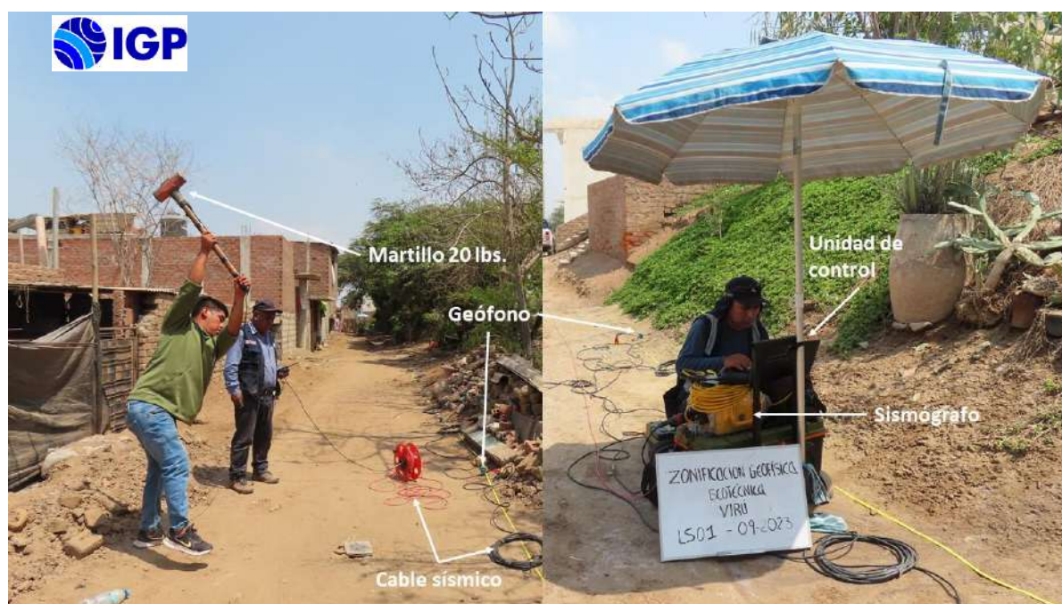
Figura 25. Equipos utilizados en la adquisición de datos MASW – MAM, en el área urbana del distrito de Virú.
