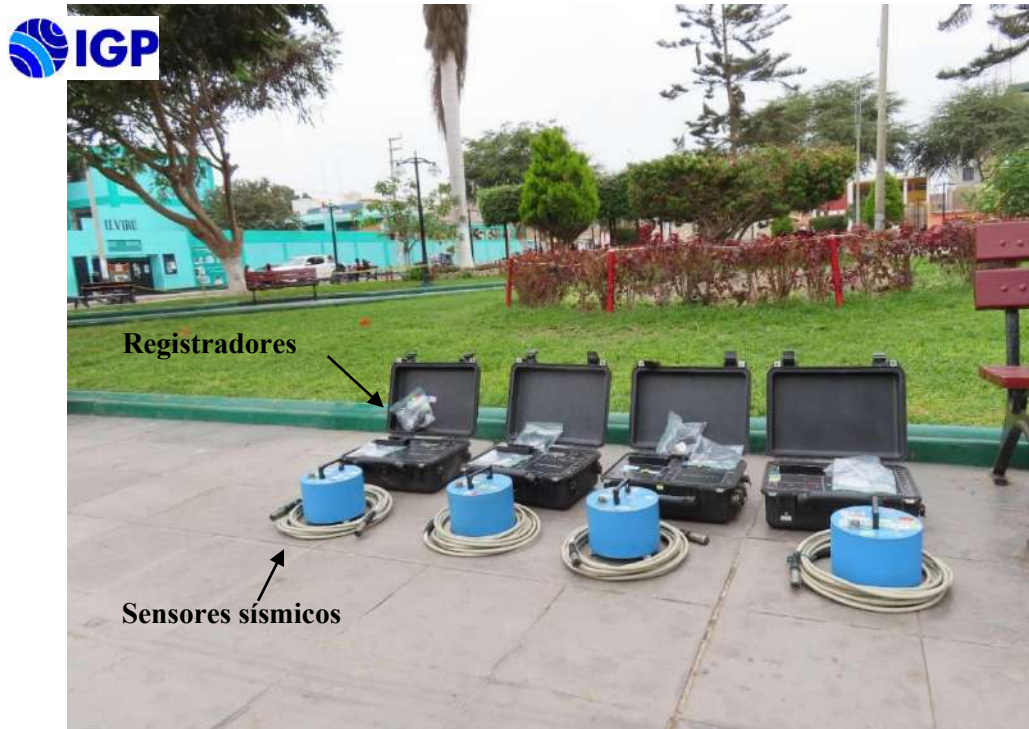
Figura 19. Equipo sísmico utilizado para el registro de vibraciones ambientales: sensor Lennartz (2N) y registradores CityShark II.
