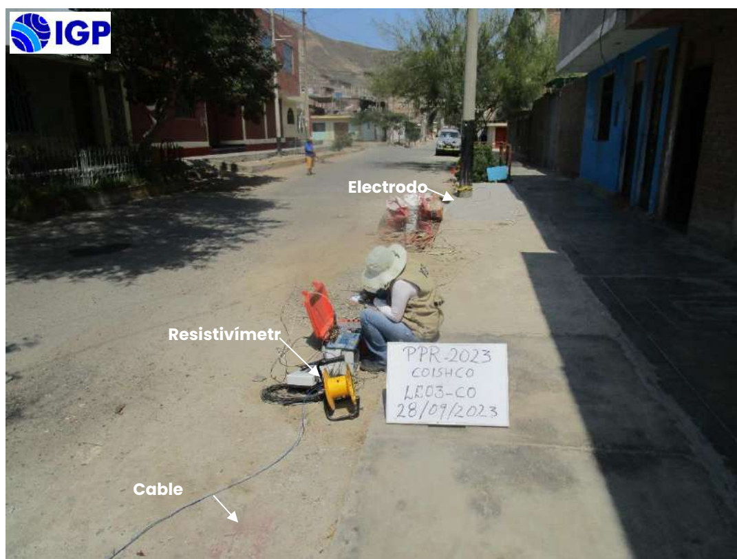
Figura 31. Equipos utilizados en la adquisición de datos ERT.
