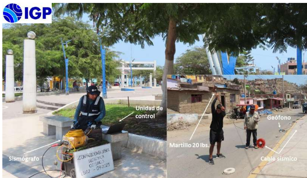
Figura 26. Equipos utilizados en la adquisición de datos MASW – MAM, en la plaza de Armas de Coishco.
