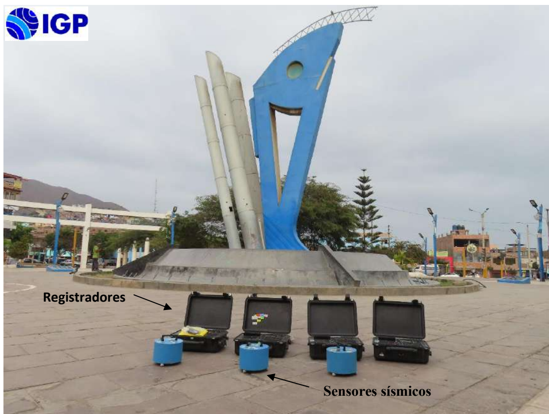
Figura 20. Equipo sísmico utilizado para el registro de vibraciones ambientales: sensor Lennartz (2N) y registradores CityShark II.
