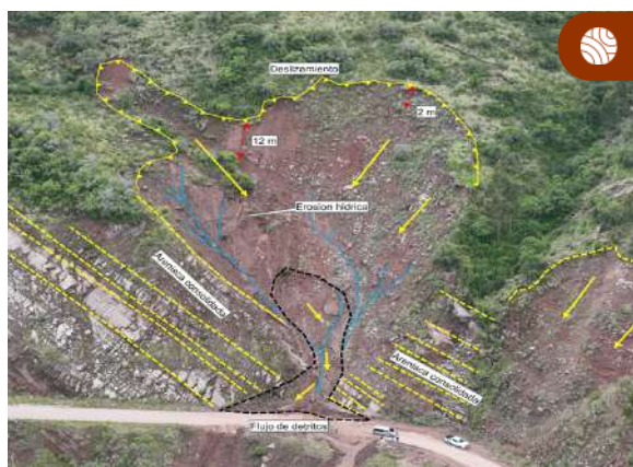
Figura 30. Se delimitó la escarpa del deslizamiento (línea amarilla) en el sector Ccantuscalla, la ocurrencia de flujo de detritos en la parte media de la ladera (línea negra) y derrumbe (línea interlineada amarilla).
