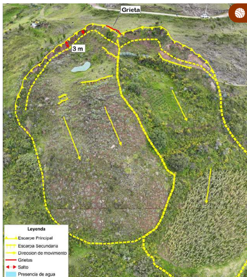
Figura 36. Deslizamiento tipo rotacional en el sector de Cucuchiray.
