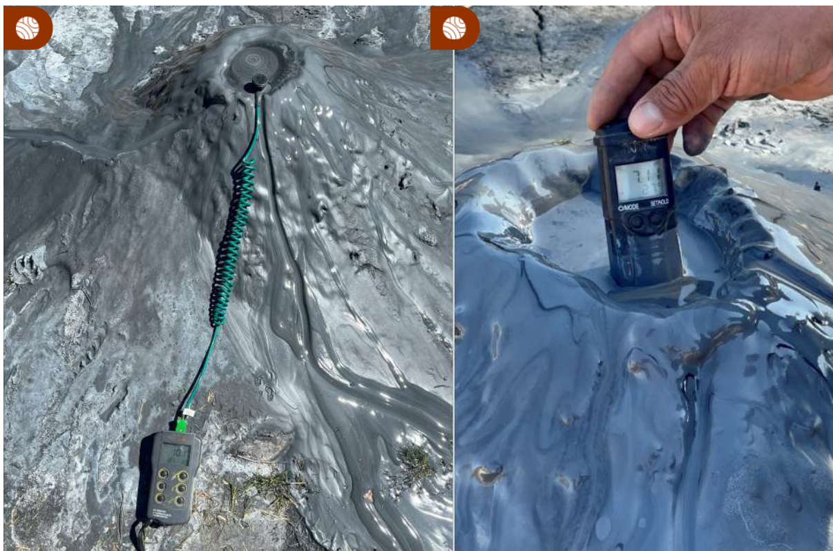
Figura 6. Medición de temperatura con termómetro Hanna (izquierda) y con equipo multiparámetro (derecha).
