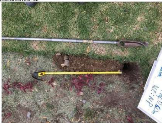
El tipo de suelo reconocido mediante el ensayo de posteo es grava bien graduada con arena
