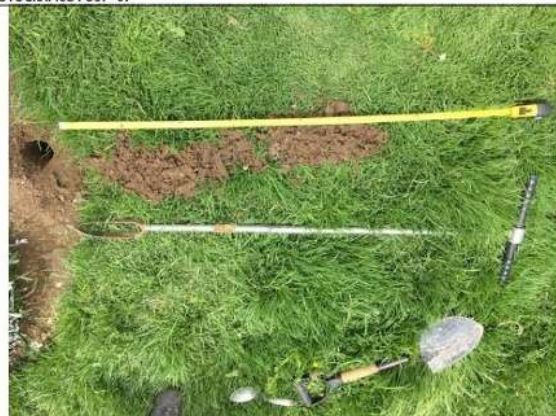
El tipo de suelo reconocido mediante el ensayo de posteo es arena arcillosa
