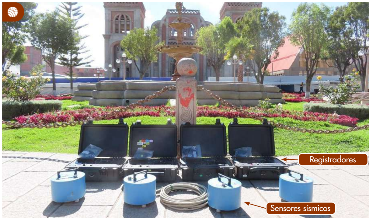
Figura 18. Equipo sísmico utilizado para el registro de vibraciones ambientales: sensores Lennartz (3 componentes) y registradores CityShark II.
