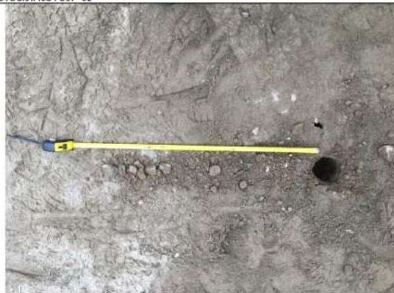
El tipo de suelo reconocido mediante el ensayo de posteo es arena bien graduada.
