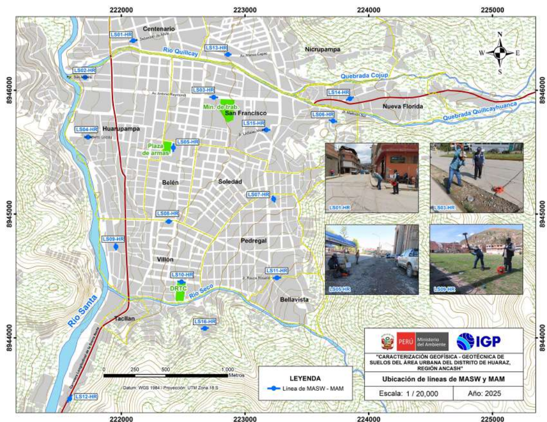
Figura 25. Distribución espacial de líneas de MASW-MAM, codificadas como LS01-HR-LS16-HR.
