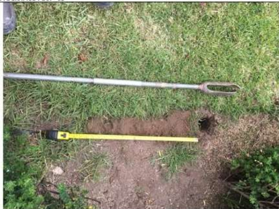
El tipo de suelo reconocido mediante el ensayo de posteo es material de relleno
