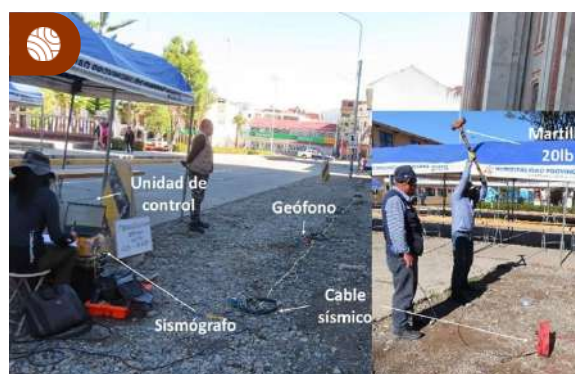
Figura 24. Equipos utilizados en la adquisición de datos MASW-MAM en la plaza de Armas de Huaraz.
