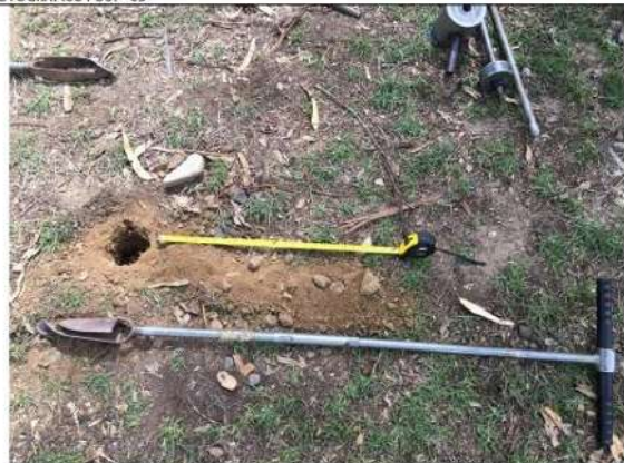
El tipo de suelo reconocido mediante el ensayo de posteo es arena limosa con grava
