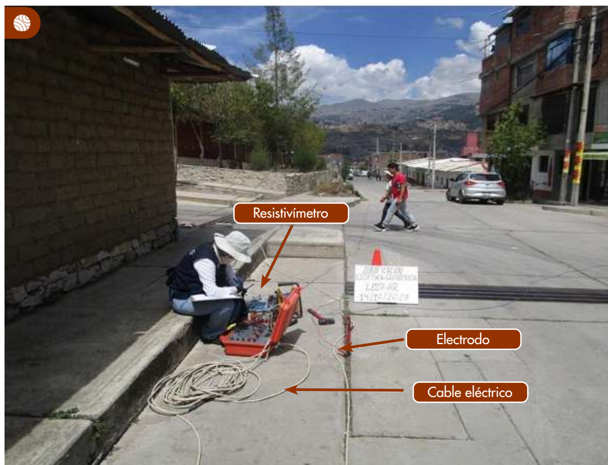
Figura 29. Equipos utilizados en la adquisición de datos ERT.
