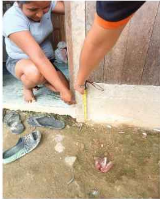
Equipo técnico identificando huella de inundación
