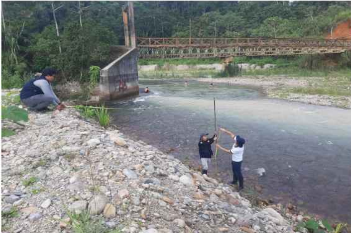
Medición de nivel de altura de defensa ribereña provisional en le río Marta
