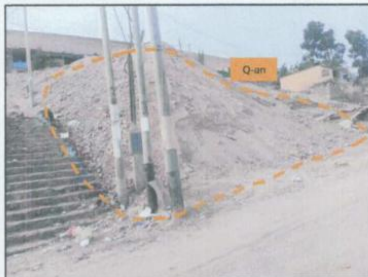
Figura 14. Identificación de la unidad Depósito antrópico (Q-an) en el proyecto
