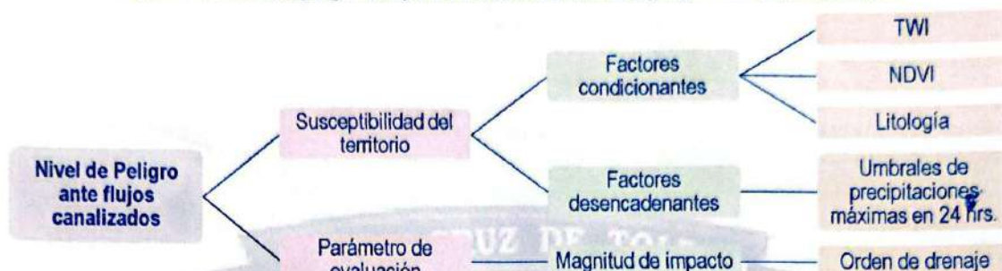
Figura 14. Metodología general para determinar el nivel de peligro ante flujo de detritos
