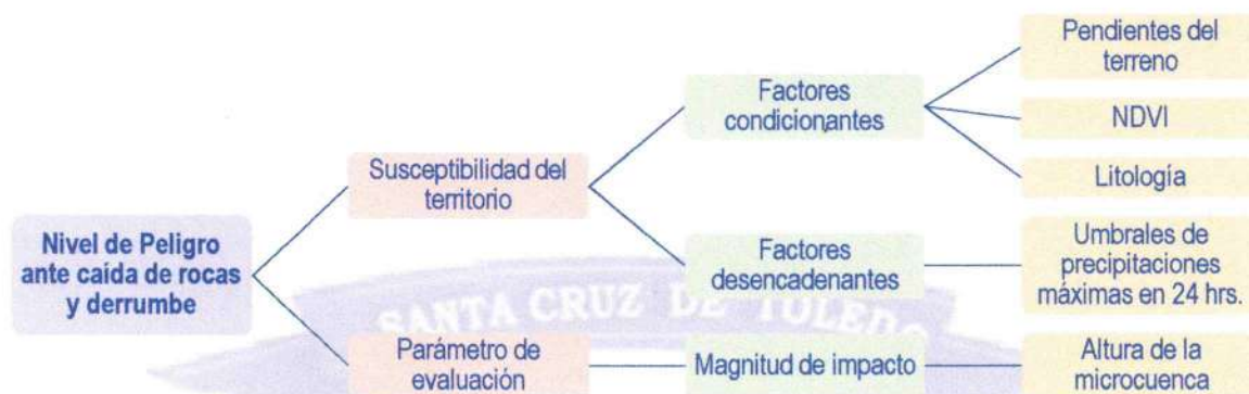
Figura 12. Metodología general para determinar el nivel de peligro ante caída de rocas y derrumbe.
