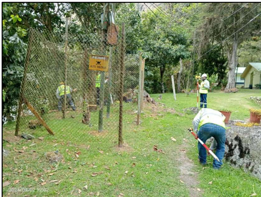
Foto 8: Levantamiento de puntos auxiliares de control
