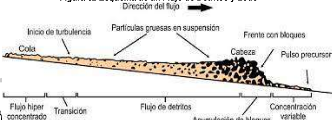
Figura 62 Esquema de un Flujo de Detritos y Lodo
