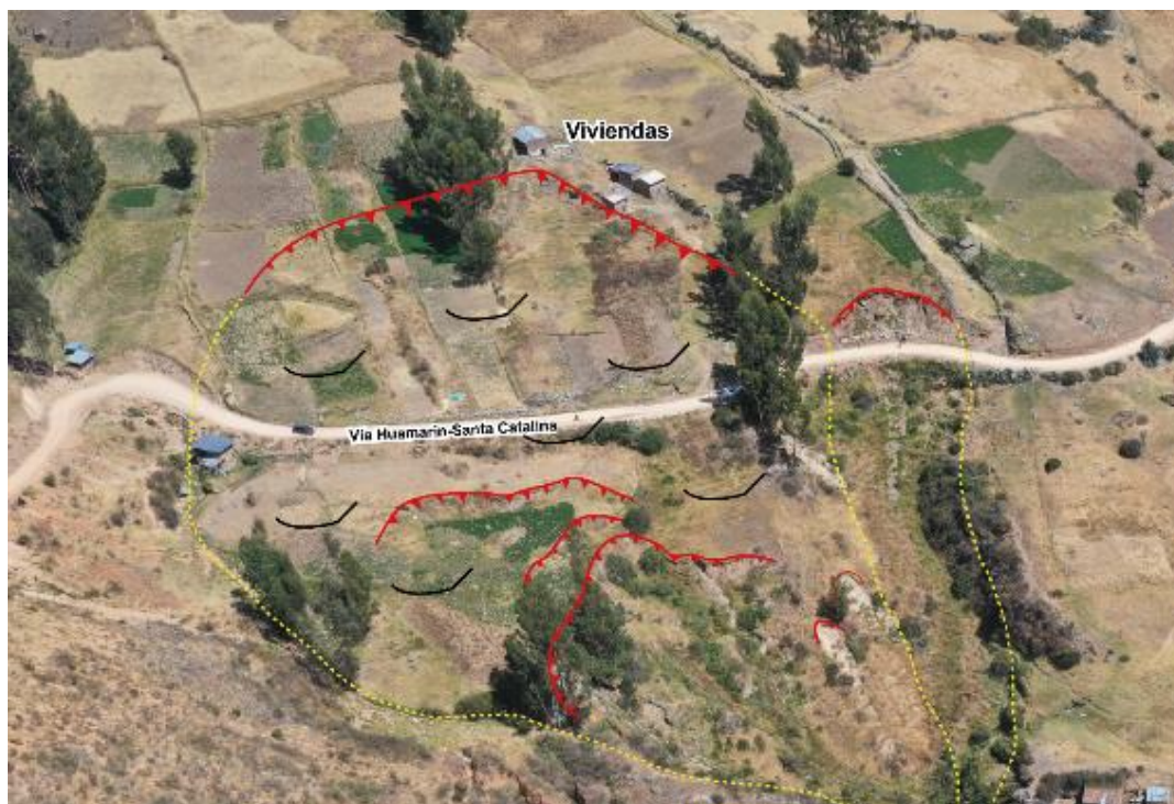
Figura 6: Vista del deslizamiento en proceso de reactivación donde se observan terrenos de cultivos y de alfalfa que presentan escarpes secundarios con saltos de 1.60m a 2.10 m.
