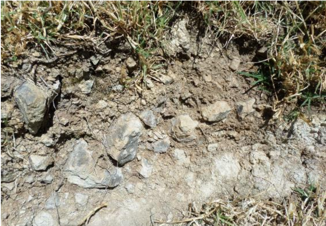
Fotografía 2. Depósito coluvio-deluvial conformado por fragmentos de rocas volcánicas angulosos a subangulosos (25%), gravas (30%), envueltas en matriz limo-arcilloso (45%)
