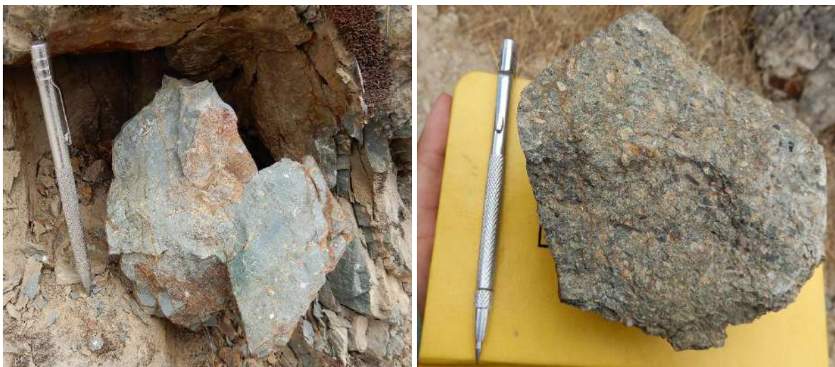
Figura 4. Vista macroscópica de rocas volcánicas tipo brechas andesíticas del Grupo Calipuy.
