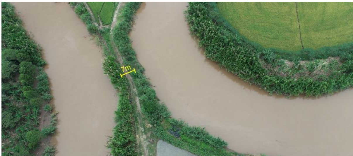
Figura 11. Cauce meándrico en proceso de estrangulamiento del río Tonchima. Se observa el estrechamiento del cauce (7m) cerca de los cultivos de arroz. Coordenadas UTM E:
