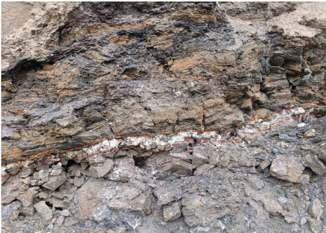
Figura 24. Niveles de yeso interestratificado entre lutitas y areniscas. Esto constituye como un factor desfavorable debido a su comportamiento soluble incrementando la susceptibilidad del macizo a movimientos en masa.
